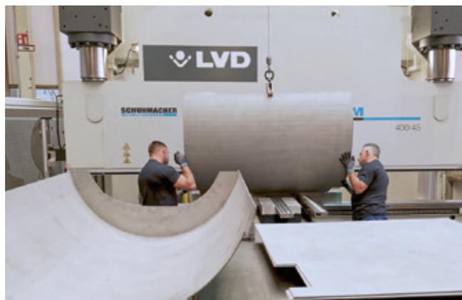
Easy-Form Abkantpressen: Easy-Form 400/45 und Easy-Form 135/30 mit je 400 t Druckkraft, 4,5 m Biegelänge bzw. 135 t / 170 t Druckkraft, 3 m Biegelänge. © LVD
