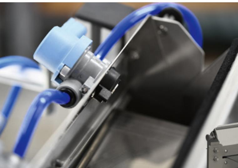
Alle Sprühbeölungssysteme arbeiten druckluftfrei mit hochfrequent pulsierenden Ventilen – das sorgt für einen präzisen Ölauftrag. © technotrans SE
