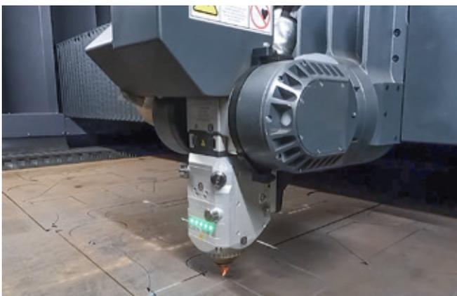
Bevelschneidkopf: Taurus ermöglicht Bevel-Schneiden bis zu 50°, wodurch hochwertige Schweißnahtvorbereitungen und komplexe Geometrien realisiert werden können. © LVD
