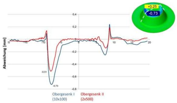
Bild 4: Erfassung des losgrößenabhängigen Werkzeugverschleißes entlang der Schnittlinie durch den Punkt des maximalen Verschleißes für die Gesenke I und II
