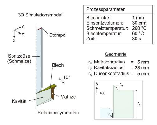
Abbildung 4: Simulationsmodell des Freiumformprozesses
