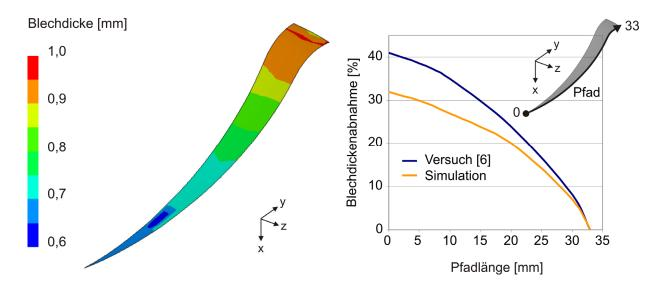
Abbildung 7: Blechdickenverlauf und -abnahme
