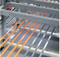
Die flache Form von Busbars bietet viele Vorteile: höhere Stromleitfähigkeit, platzsparender Einsatz, automatisierte Verarbeitung. Um die wichtige Aufgabe der Stromversorgung in den Fahrzeugen von morgen sicher zu erfüllen, ist kompromisslose Qualität bei der Busbar-Isolation gefragt.
